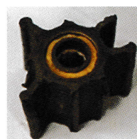
劣化した 海水ポンプインペラ
